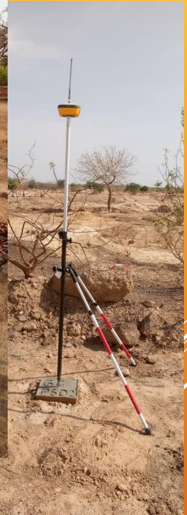
Levés topographiques au GPS Différentiel
